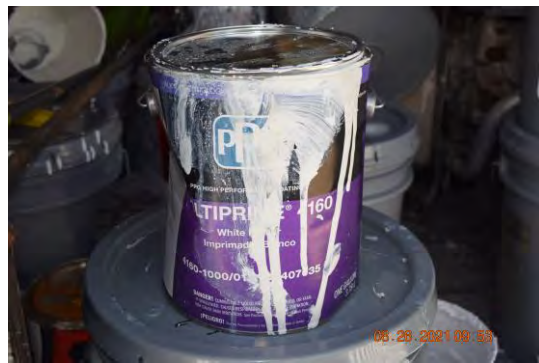
Foto 4: Material utilizado para la aplicación de "primer" en las superficies de metal (railings). (MULTIPRIME 4160)
