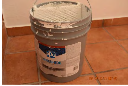
Foto 6: Material utilizado para la aplicación de segunda capa de pintura en los recortes de las paredes del edificio 3 (C). (SPEEDHIDE 6-610XI)
