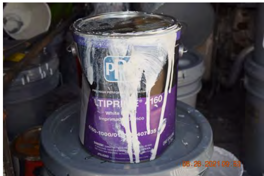
Foto 3: Material utilizado para la aplicación de "primer" en las superficies de metal (railings). (MULTIPRIME 4160)
