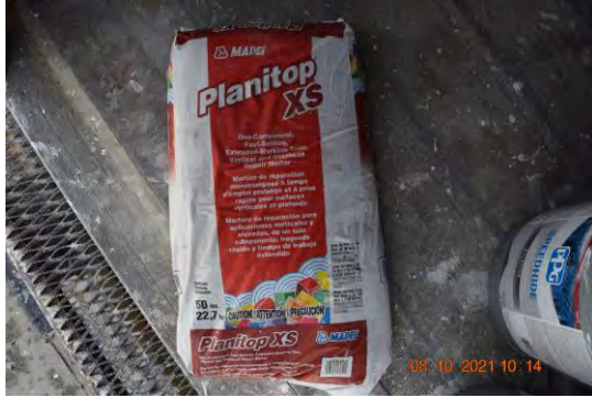
Foto 13: Material utilizado para labor de aplicación de cemento en el parapeto del edificio. (MAPEI Planitop XS)
