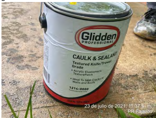
Foto 7: Material utilizado para reparación de grietas en el edificio. (Glidden Professional – Caulk & Sealant, Textured Knife/Trowel Grade)
