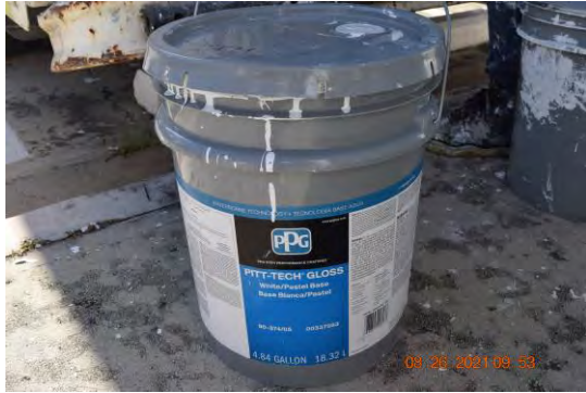
Foto 5: Material utilizado para la aplicación de pintura en las superficies de metal (railings). (PITT-TECH GLOSS [90-374/05 - 00337993])
